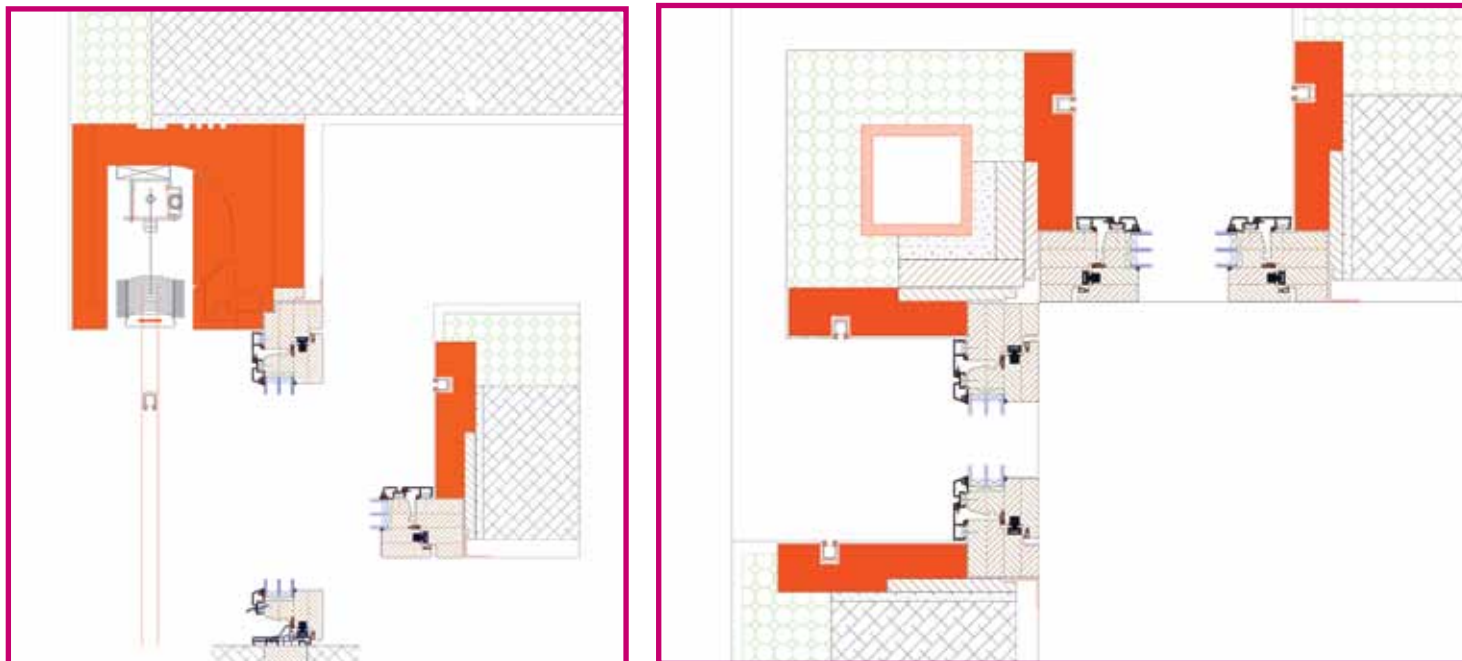
Sopra: sezioni di dettaglio del serramento in legno-alluminio Aluclima design.
